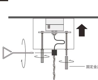
シーリングカップを押上げ固定金具で固定します、マイナスドライバーでコードストッパーを取り付けます。
