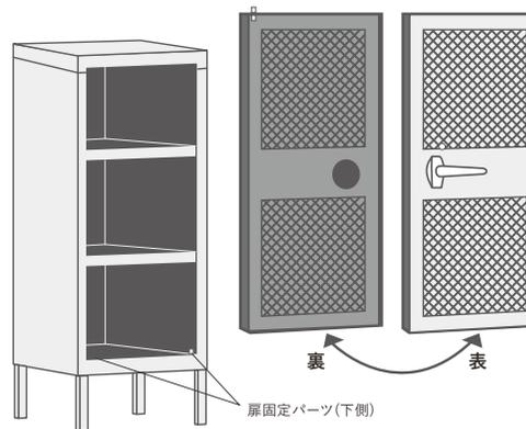
4 扉下側の穴に扉固定パーツを通し、扉上側の金具を下へ押し込みながら、本体へ取り付けます。
