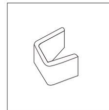
棚板は上図のようなプラスチックで固定されています。こちらは輸送時の補強材となりますので、不要な場合は取り外して使用してください。
