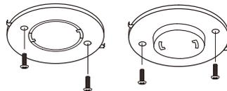
**2** 埋込ローゼット取付用ネジでローゼットに取付けてください。外側が短ネジに、内側が長ネジになります。
